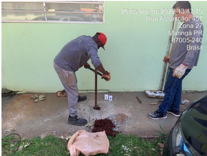
Foto nº 7: Vista do técnico procedendo a perfuração do solo com o auxílio de trado manual.
