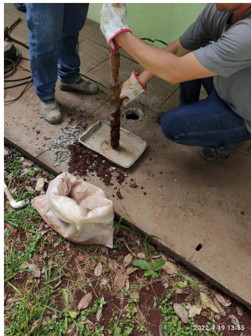
Foto nº 8. Vista do técnico coletando a amostra do solo.
