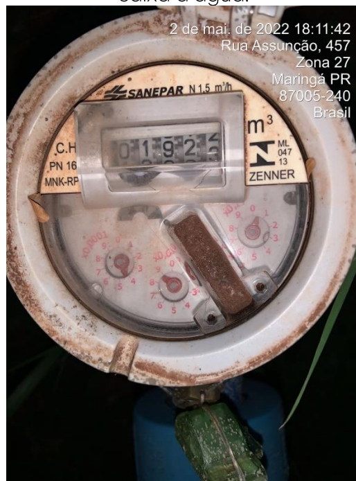
Foto nº230: Aferição do hidrômetro após 15 minutos da primeira medição.
