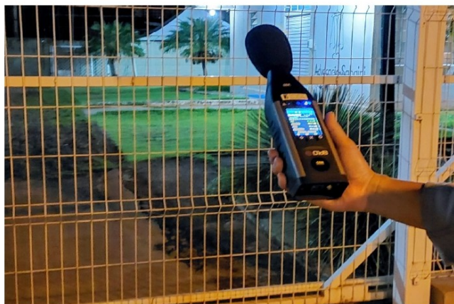
Figura 5: Sonômetro instalado no Ponto 4
