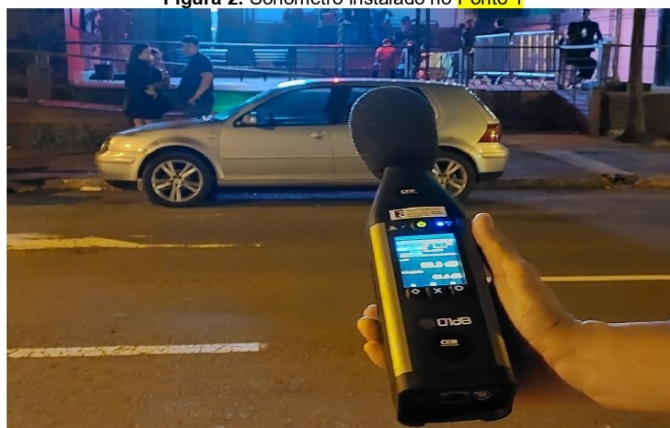
Figura 2: Sonômetro instalado no Ponto 1
