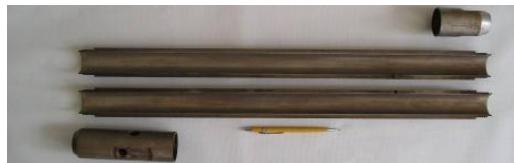
Figura 4. Amostrador padrão do tipo Raymond, aberto.
