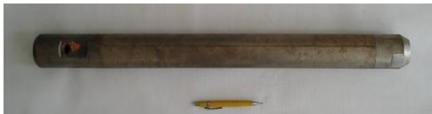
Figura 3. Amostrador padrão do tipo Raymond, fechado.
